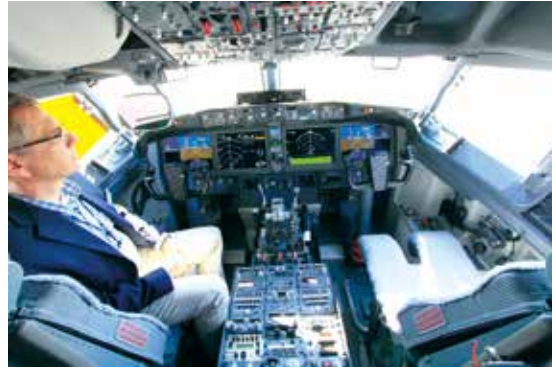
ボーイング737MAX9のコックピット。 737MAXはどのタイプでもコックピットの基本 設計は同じ
