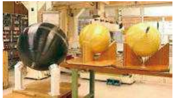
左：衛星用ヘリウムタンク 右：Ariane-5用300Lヘリウムタンク (写真提供：ASL)
