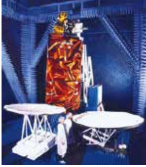
左：電波暗室での受動アンテナ試験、右：能動アンテナ（写真提供：TAS）
