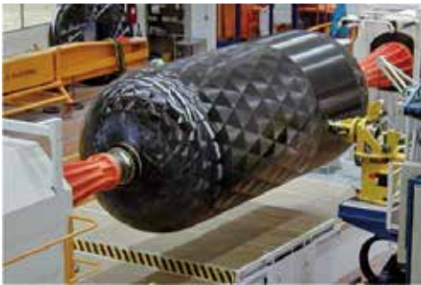
左：衛星用ヘリウムタンク 右：Ariane-5用300Lヘリウムタンク (写真提供：ASL)
