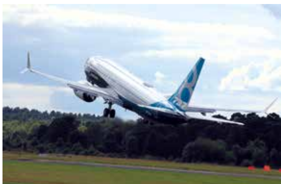
デモフライトに向け離陸するボーイング737 MAX 8。主翼端のATウイングレットが大きな特徴
