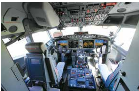
ボーイング737 MAX 8 コックピットの設計上の制限から、新世代機の737 MAXでもヘッド・アップ・ディスプレイは機長席にしか付けられない
