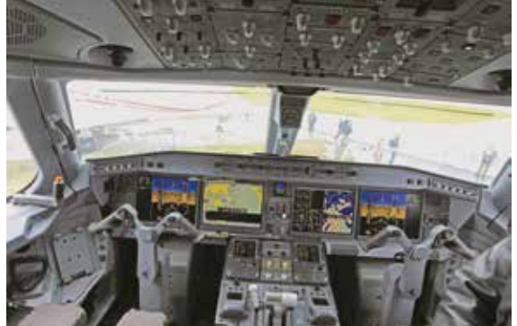
E2-195のコックピット。ハニウェルのプリマス2が使われていて、オプションで両席にヘッド・アップ・ディスプレイを付けられる。
