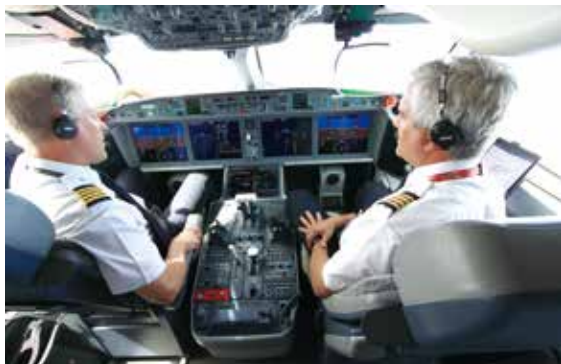
体験搭乗飛行中のCS100のコックピット。計器システムはMRJと同じ、ロックウェルコリンズのプロライン・フューチャーで、CS100では機長席と副操縦士席の双方にヘッド・アップ・ディスプレイが標準装備されている
