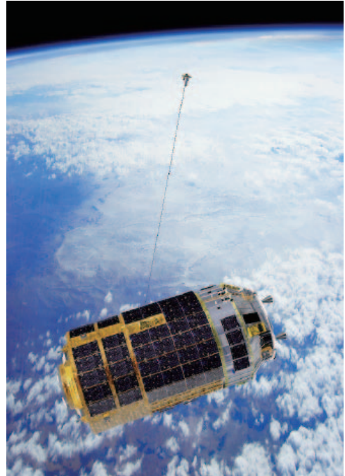
写真1 HTV6号機による導電性テザー実証実験（KITEミッション）
