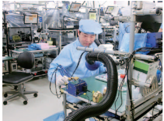
ASNARO-2搭載プリント基板の製作
